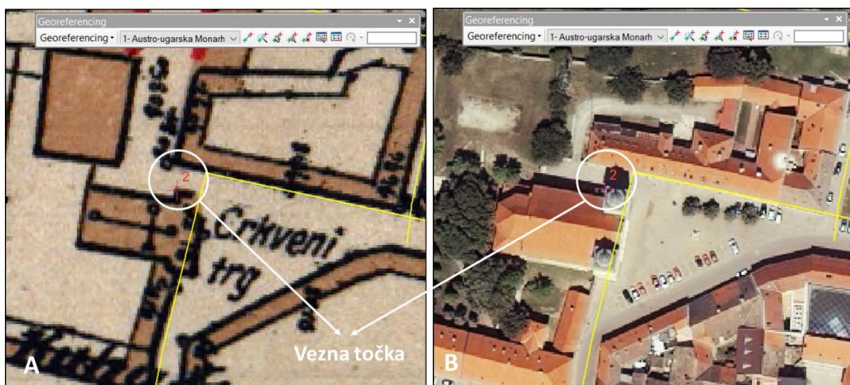
Slika 21. Vezna točka odabrana na prepoznatljivoj lokaciji unutar gradske četvrti Tvrđa (A – digitalizirani kartografski prikaz; B – georeferencirani DOF iz 2018. godine)
