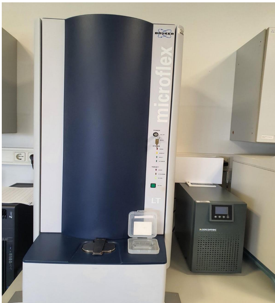
Slika 5. MALDI TOF uređaj
