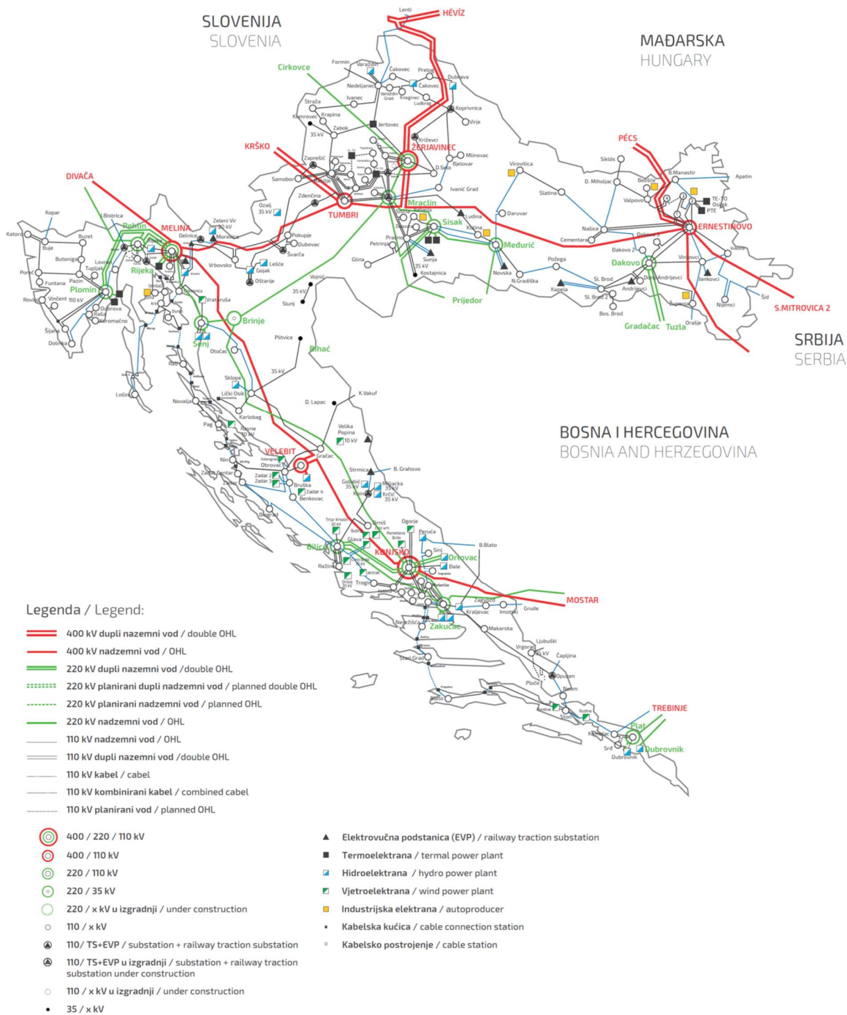
Slika 3. Shema visokonaponskog dijela elektroenergetskog sustava RH (Izvor: Godišnje izvješće HOPS d.o.o., 2020. str. 100)
